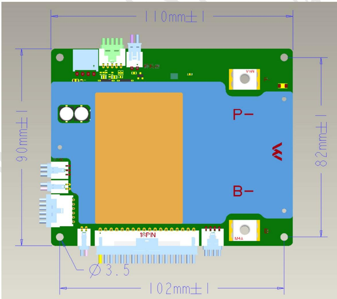
保护板尺寸：110\*90\*12【固定孔位中心尺寸102\*82，固定孔位螺丝M3】
