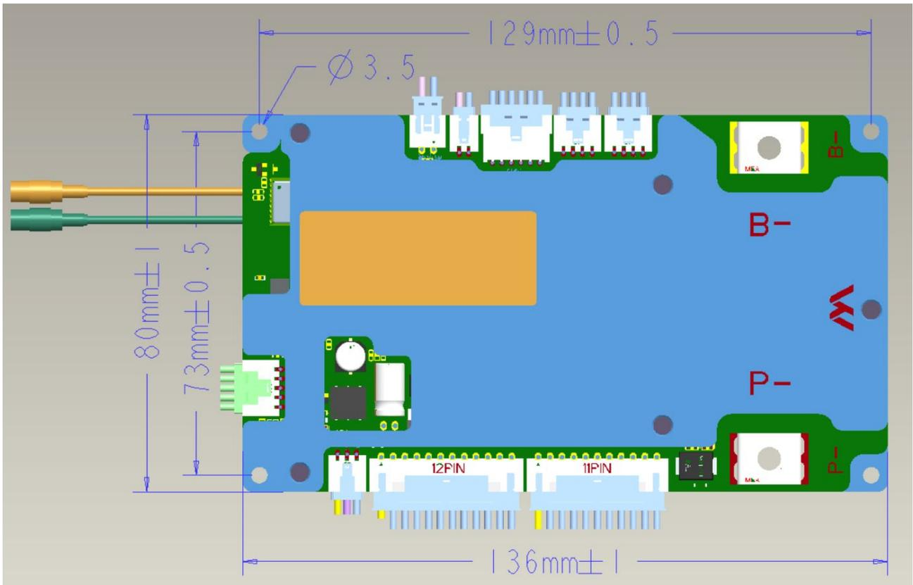
保护板尺寸：136\*80\*13.6（局部高度16）【固定孔位中心尺寸129\*73，固定孔位螺丝M3】
