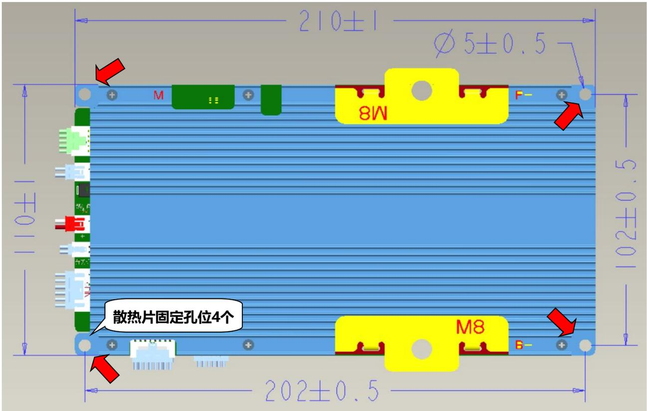
保护板尺寸：210\*110\*21【固定孔位中心尺寸202\*102，固定孔位螺丝M4】（mm）
