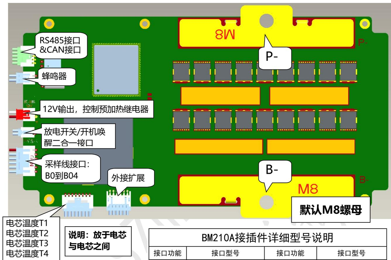
**重要说明：电池采样线材、温度线、RS485通讯线等插接的线材，装好后要打胶固定，防止电池使用过程中震动脱落。**
